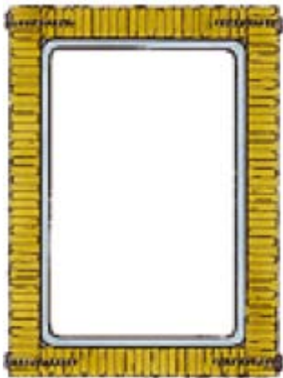
Figur 9: Stålsøyle pakket inn i steinullplater på 4 sider
