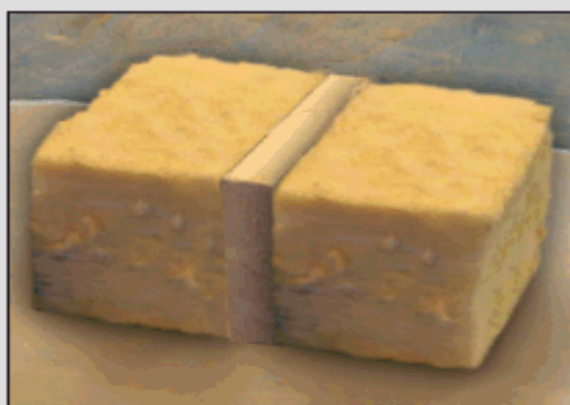
Trekonstruksjon isolert med 150 mm glassull før test.
