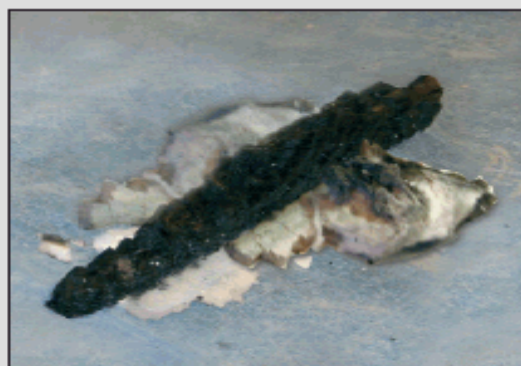
Brannpåvirkning av trekonstruksjon med glassull etter 50 minutter.
