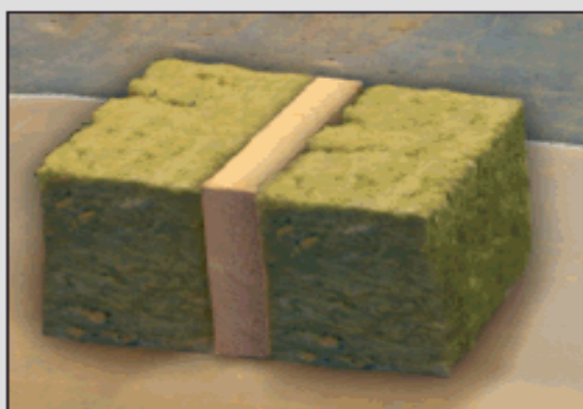
Trekonstruksjon isolert med 150 mm Rockwool før test.
