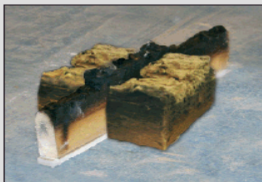
Brannpåvirkning av trekonstruksjon med Rockwool etter 50 minutter.
