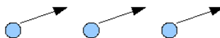
Figur 9: Her vil det i svært liten grad bli varmeutveksling mot venstre sammenlignet høyre retning. Sirklene illustrerer temperaturpunkt, pilene representerer retningen og styrken på lufttrekken i punktet.
