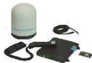
Figur 4.1: Bilde av mini-M TT3064A (maritim versjon)
