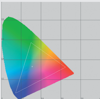
Fig. 5.24 videomonitor med spektrolino (xy-fargerom)
