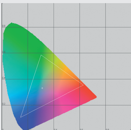
Fig. 5.22 LCD med spektrolino (xy-fargerom)
