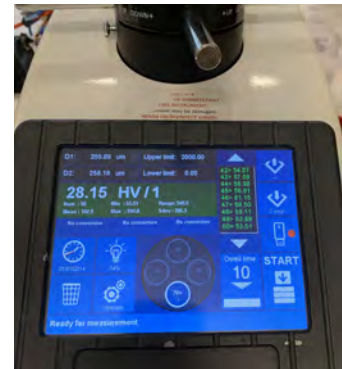
(c) Databordet av Vickers-test.
