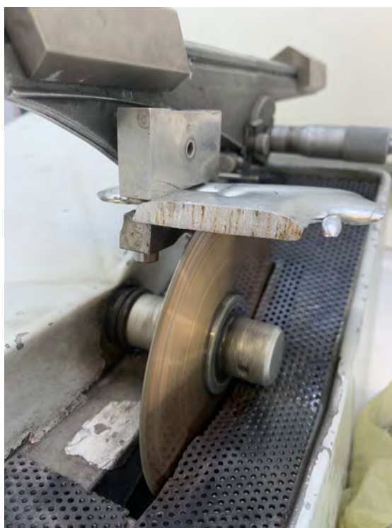
Figur 3.4.2: Finkuttemaskin som ble brukt for å kappe ut mindre biter som skulle prepareres.
